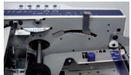
TF MEGA-A: Justierung von Blattanpressdruck und -separierung für unterschiedliche Papierstärken
