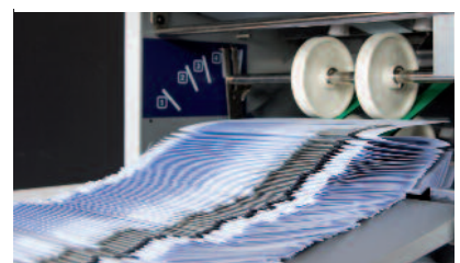
Große, ausziehbare Schuppenablage für bis zu 300 gefaltete Blätter
